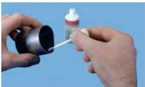
Адгезионная прослойка для вклеивания вязких прокладок в опокое кольцо предотвращает пригорание формовочной массы к металлу в зоне контакта и упрощает разупрочнение формы.
