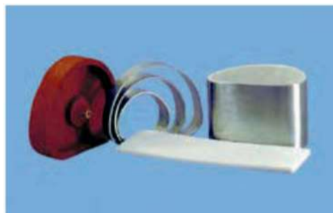
Стальное опоковое кольцо специальной формы для „bredent-техники литья по Sabath“
