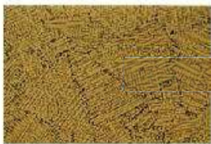
Дендриты и хрупкие включения в структуре при избытке кислорода в пламени
