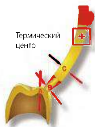
A = Толщина стенки коронки B = Диаметр канала в месте крепления C = Диаметр литникового канала
