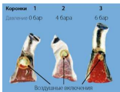
Результаты литья коронок при формовке под давлением от 0 до 6 бар
