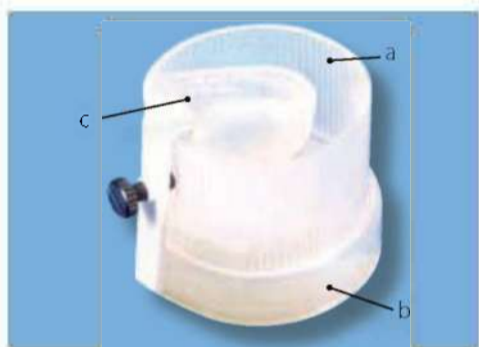
(а) силиконовое кольцо опоки + (б) форма основания и (с) регулировка расширения
