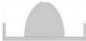
Литниковая воронка с неправильным направлением заполнения расплавом
