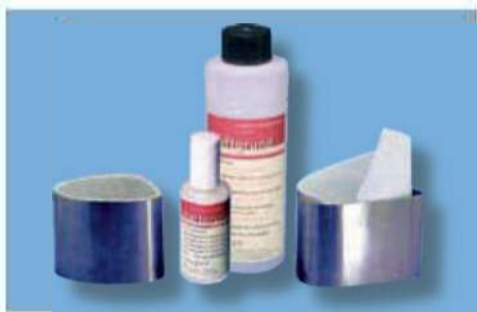
Синтетический клей/адгезионная прослойка при формовке в стальное кольцо
